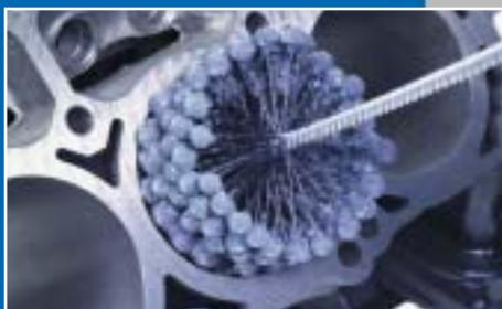
Окончательная обработка отверстия цилиндра
